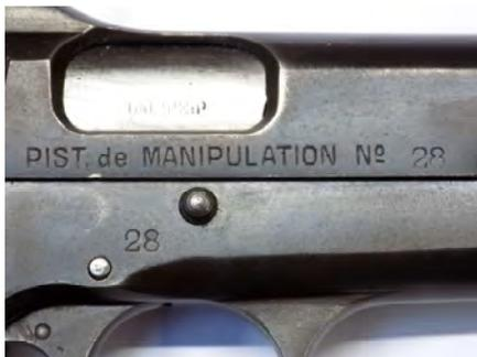
(1) Les fenêtres d'éjection sur les glissières des modèles « oval port » sont arrondies des deux côtés de la découpe, sur les modèles de série seule le côté droit le sera encore, le côté gauche devient droit.
